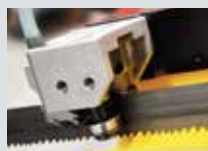
Sägebandführung aus Hartmetall
