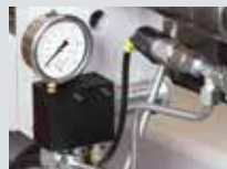
Spanndruckregelung des Spannstocks
