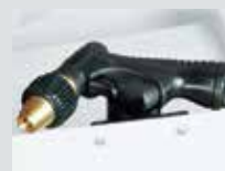
Pistole für das Abspülen der Späne (Option)
