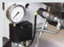
Spanndruckregelung des Spannstocks
