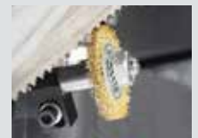
Angetriebene Späneräumbürste
