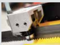
Sägebandführung aus Hartmetall
